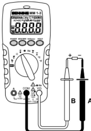
Bild 8: Durchgangsprüfung mit Summen
